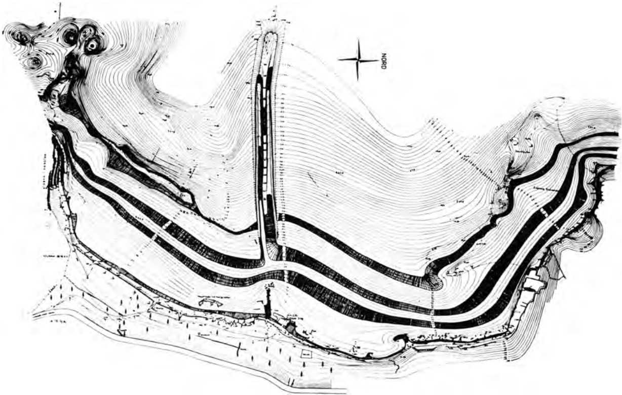
Abb. 6. Darstellung verschiedener Meeresspiegelhöhen im Hinblick auf die Wirksamkeit des großen Wellenbrechers.
