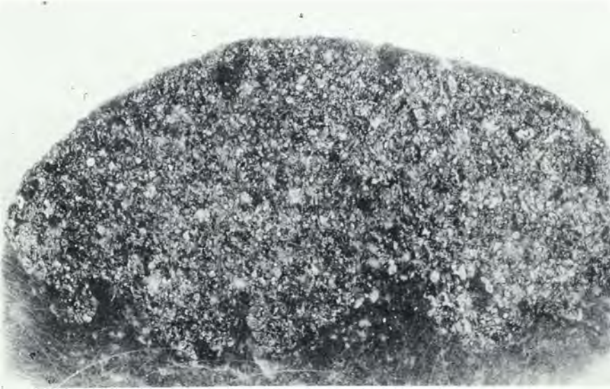
Εικ. 2. Επιτυχημένο αιγυπτιακό μπλε στο οπτικό μικροσκόπιο.
