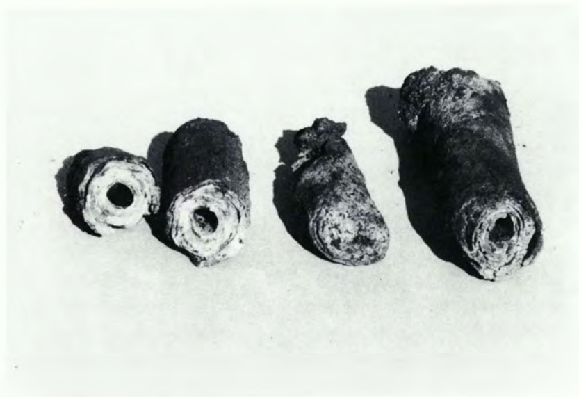
Εικ. 5. Κως, Οικόπεδο Δάμτσα, Λείψανα. Σωληνωτοί λιθάργυροι.
