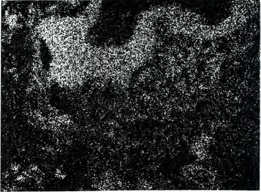
Εικ. 17. Φωτογραφία μικροανάλυσης με ακτίνες X ως προς χαλκό (Cu, 480X, 4) στην ίδια περιοχή που απεικονίζεται στις εικ. 14, 15 και 16.
